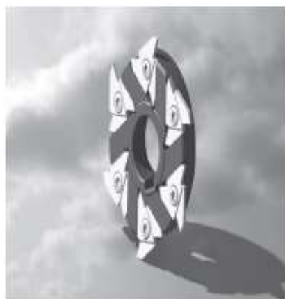
Рис. 1. Модель разработанной прорезной фрезы.
