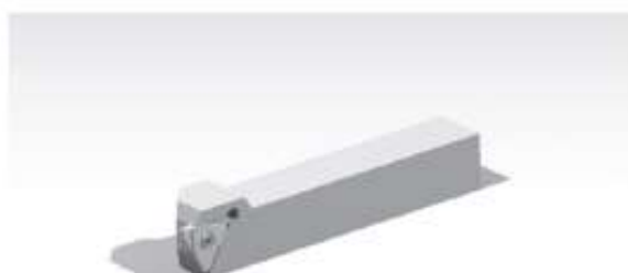
Рис. 1. Модель разработанной прорезной фрезы.
