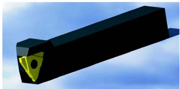
Рис. 6. Модель базовой конструкции канавочного сборного резца с СМП
