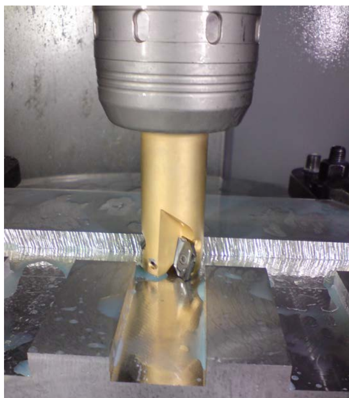
Рис. 8. Черновая обработка паза концевой фрезой Iscar HM90 EAL-D32-C32-L150-15
